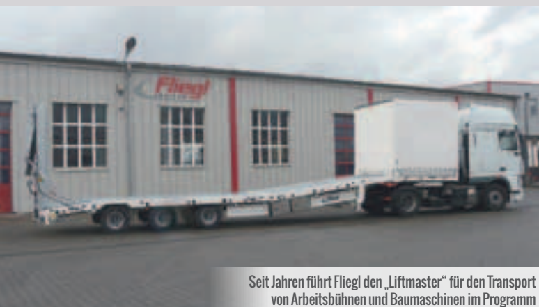
Der MAX410, ein zwangsgelenkter 4-Achs-Plateau-Auflieger
