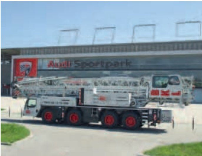
» Einen Liebherr MK 88 Plus hat die BKL Baukran Logistik am neuen Standort Ingolstadt in Empfang genommen. Standortleiter Rainer Speich freut sich vor allem über die Option ‚Plus‘: „Damit schaffen wir mit Zusatzballast eine Traglaststeigerung von etwa zehn Prozent und können auch bei 35 Meter noch 3.000 Kilogramm heben.“
