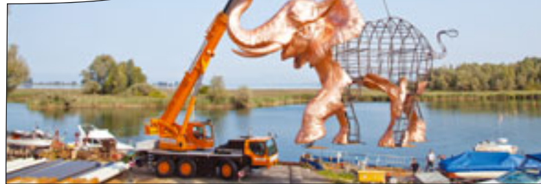
Das haut den stärksten Elefanten um: LTM 1050-3 beim Abbau der Bregenzer Seebühne
