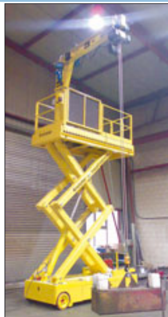
Eine Schere kombiniert mit Kran hat Kreitzler entwickelt
