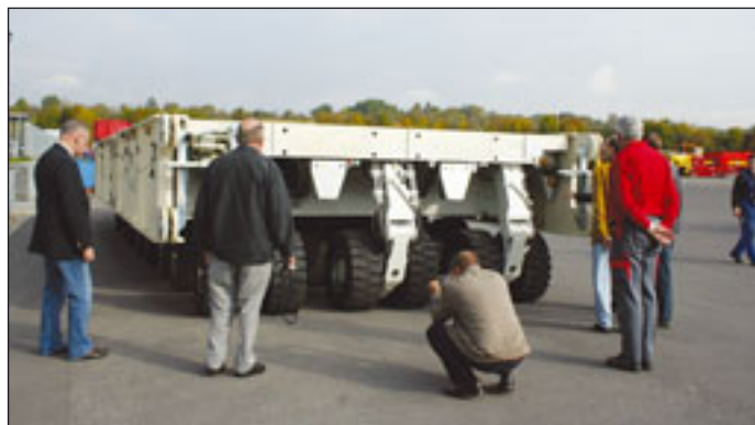
Die erstmalige Verwendung der SPMTs in einer Kombination von 3-Achsfahrwerken in Querfahrt hat Scheuerle für Multilift realisiert
