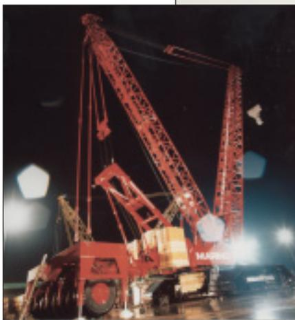
**Das SSL/LSL Hauptauslegersystem erreicht Längen von bis 150 Metern. Der CC 8800 kann in einem Arbeitsbereich von 9 Metern bis 154 Metern eingesetzt werden. Die maximale Auslegerlänge mit Verlängerung beträgt 216 Meter.**
