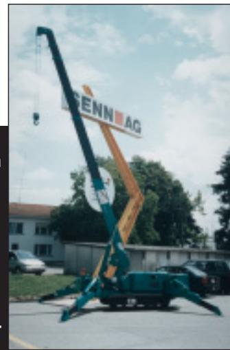
Mini-Raupenkrane mit Traglasten von rund einer bis knapp fünf Tonnen bietet Maeda an. Diese Kleinstkrane werden in Fahrbreiten zwischen 60 und 232 Zentimeter und mit Verbrennungs-, Elektro- oder Bimotor angeboten. Der Vertrieb für die Schweiz und Süddeutschland läuft über die Schweizer Senn AG in Oftringen.
