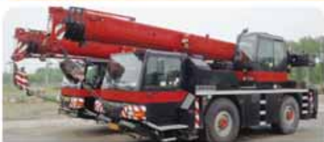
2 - LIEBHERR LTM1030-2 4x4x4 | Moerdijk, NL
