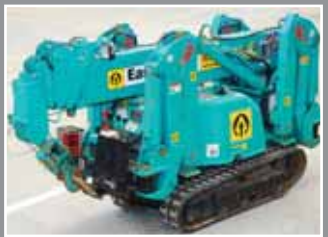
MAEDA MC 285 CRM Mini crane 8.70m/ 2.8 Tonne - 2006
