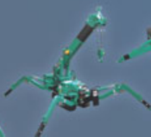
MC285 - 2,8 Tonnen Minikran Tragfähigkeit: 2820 kg/1,4 m Max. Radius: 8,21 m Max. Höhe: 8,7 m Motor: Diesel/elektrisch
