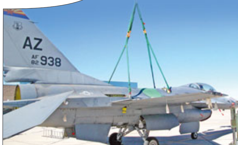
Ein Düsenjet angehängt an Poly-Ethylen-Fasern
