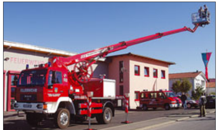
Die Wumag WT 230 F, eine Arbeitsbühne mit Zusatzausstattungen für den Feuerwehreinsatz
