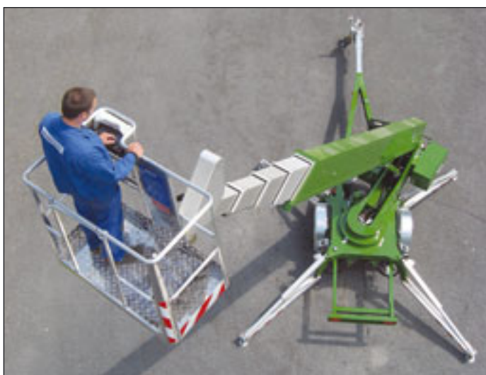
Esdas Größte, die TA2620, reicht bis in (Arbeits-)Höhen von 26 Metern
