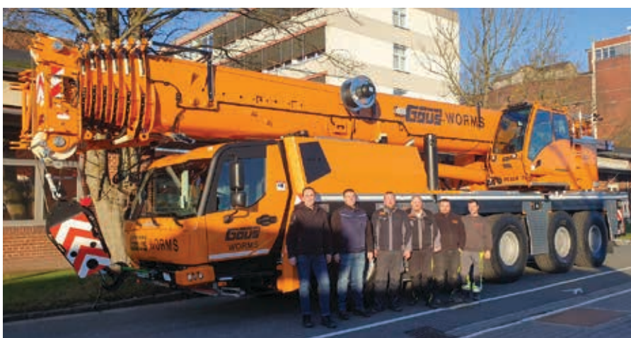
↑ Als erster Kunde in Deutschland hat Krandienst Gaus Mitte Januar einen GMK-5120L übernommen. Der neue 5-Achser ist mit seinem 66 Meter langen Hauptausleger prädestiniert für Montagetätigkeiten in großen Höhen.
