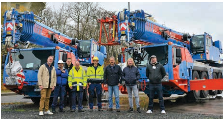
↑ Jaromin aus Oberhausen hat neue 80-Tonner vom Typ Tadano AC 4.080-1 mit E-Pack in Empfang genommen. Die neuen Vierachser verfügen über einen sieben-teiligen 60-Meter-Hauptausleger, an den sich eine 8,5 bis 16 Meter lange Doppelklappspitze anschließt.
