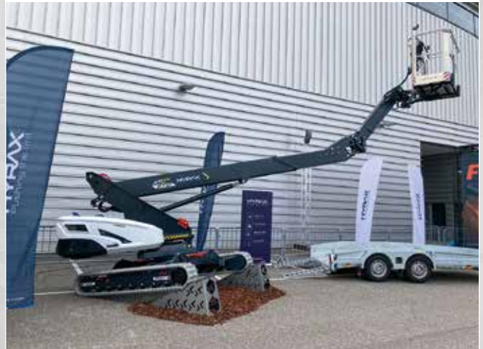
Erste offizielle Veranstaltung für die ATDe 27.12 von Hyrax: 12,6 Meter Arbeitshöhe, 270 Kilogramm Korblast
