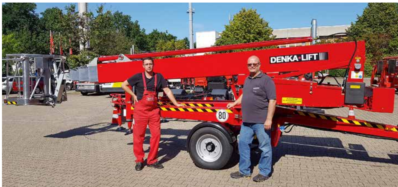
→ Punktuell aufgefrischt hat die Firma Gerken ihren Fuhrpark: mit zwei neuen Anhängerarbeitsbühnen Denka-Lift DK25. Die 25-Meter-Teleskopgeräte bieten 11,40 Meter seitliche Reichweite und 200 Kilogramm maximale Korblast.
