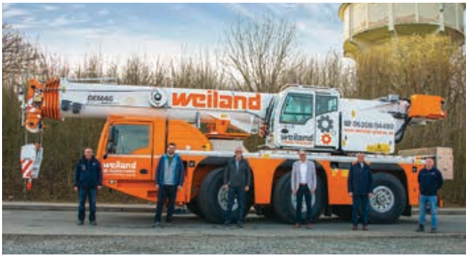
→ Weiland Kran & Transport aus Lampertheim kommt mit neuem Demag AC 60-3 All-Terrain-Kran daher. Ausschlaggebend sei unter anderem das Abstützsysteem Flex Base gewesen, mit dem sich die Stützen auch asymmetrisch stufenlos direkt bis an ein Hindernis ausfahren lassen.
