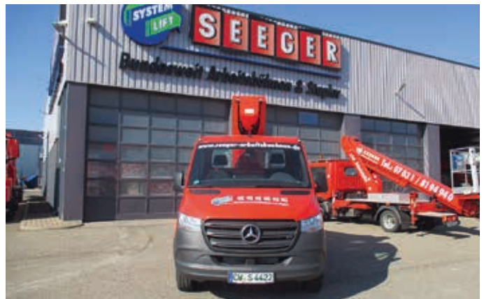
→ Trio mit vier Rädern: Die Firma Seeger hat drei Ecoline 230 von Ruthmann übernommen. Die LKW-Bühnen mit starrem Teleskopsystem bieten 23 Meter Arbeitshöhe und eine Reichweite von 16,90 Meter.
