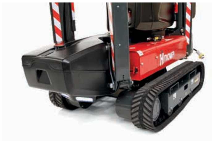
BEHÄLTER FÜR UNTERLEGPLATTEN LED-SCHNITTWERFER VORNE UND HINTEN
