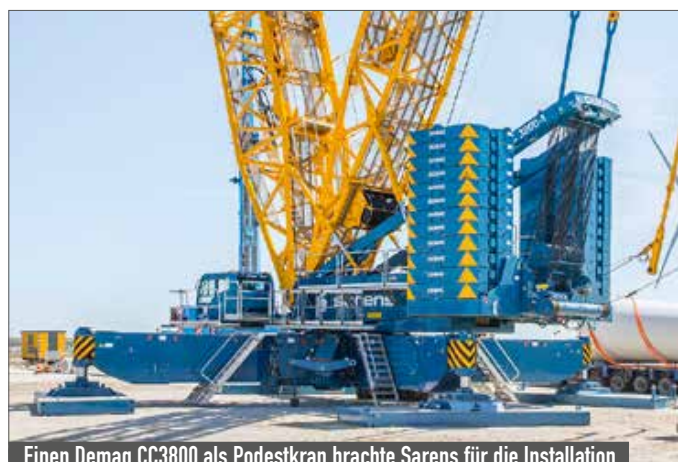
Einen Demag CC3800 als Podestkran brachte Sarens für die Installation von Windkraftanlagen in den Niederlanden zum Einsatz
