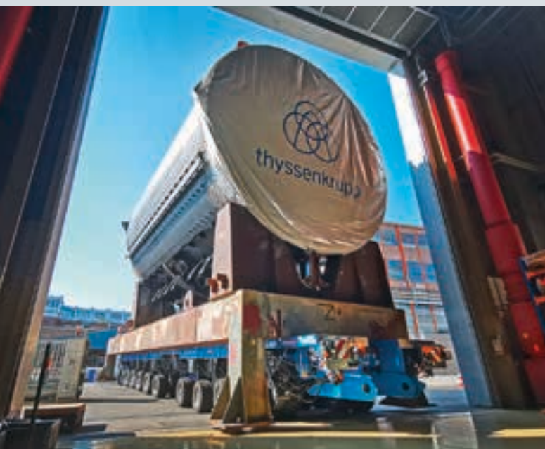
Thyssenkrupp Marine setzt für den innerbetrieblichen Transport auf SPMT von Scheuerle
