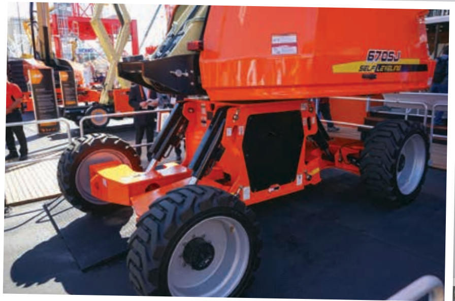
JLG mit seiner selbstnivellierenden Teleskopbühne 670SJ, deren Prototyp schon 2017 hier gezeigt wurde
