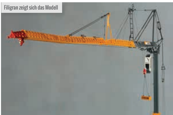
Der Ausleger ist aus Aluminium
