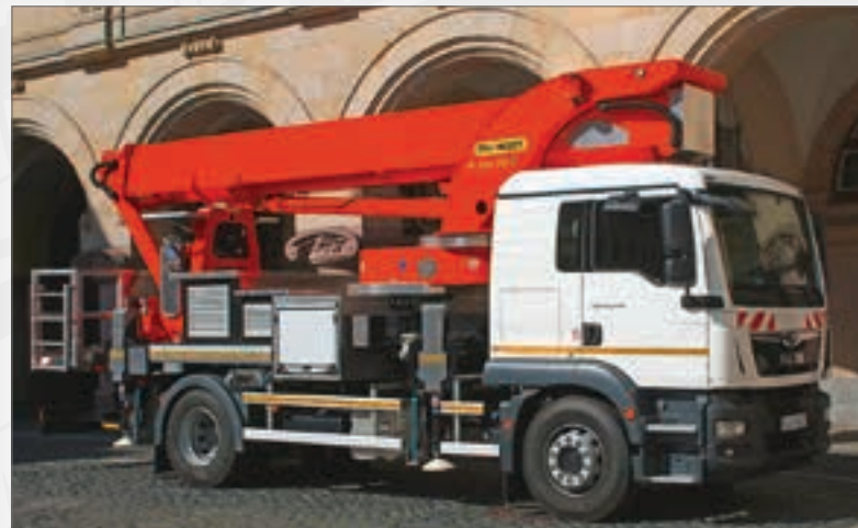
Die Palfinger P 370 KS E mit Elektroantrieb für die Bühne
