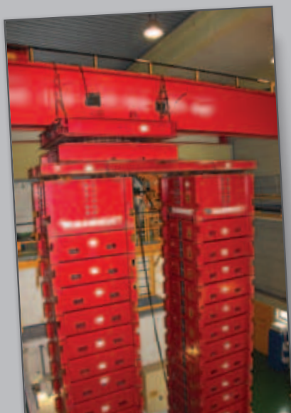
Mammoets Push-Up System Enerpac JS 500 mit Turntable (Foto: JEN)
