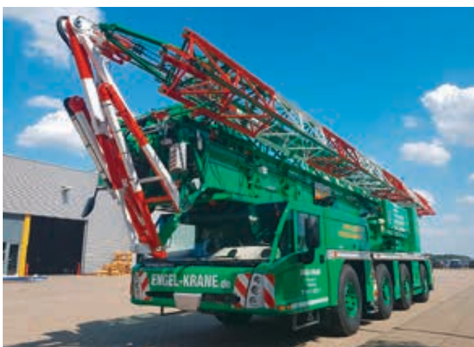
Engel-Krane aus der Nähe von Magdeburg hat einen neuen Spierings-Falken übernommen. Der SK597-AT4 ist bereits der zweite Mobilbaukran im Fuhrpark. „Mit 48 Meter Ausladung ist er nach unserer Ansicht der beste Kran seiner Klasse. Das sehr gute Verhältnis zum Hause Spierings erleichterte uns die Investitionsentscheidung sehr“, erklärt Geschäftsführer Ringo Engel. <<
