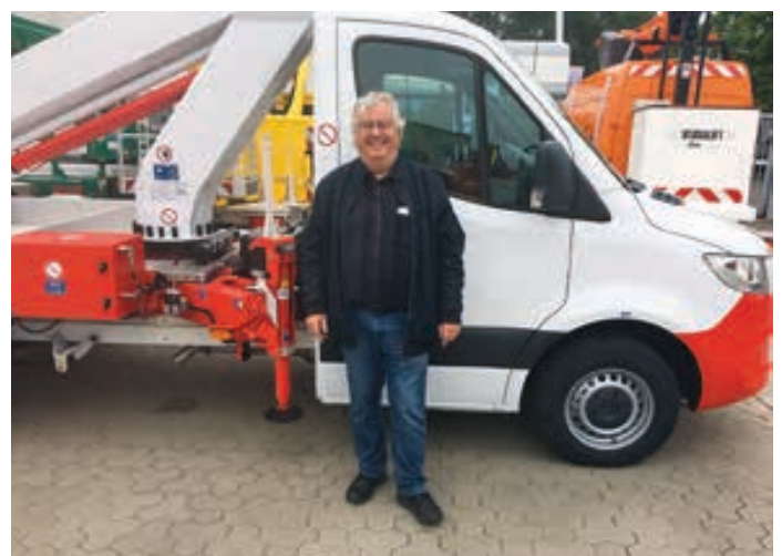
Hans-Peter Spielhoff vom Arbeitsbühnenvermieter Spielhoff aus Wuppertal ließ es sich nicht nehmen, die neue 3,5-Tonnen-LKW-Bühne von Ruthmann persönlich abzuholen: einen TB 220 mit 22,1 Meter Arbeitshöhe und einer Reichweite von 14 Metern bei reduzierter Korblast von 100 Kilogramm. <<
