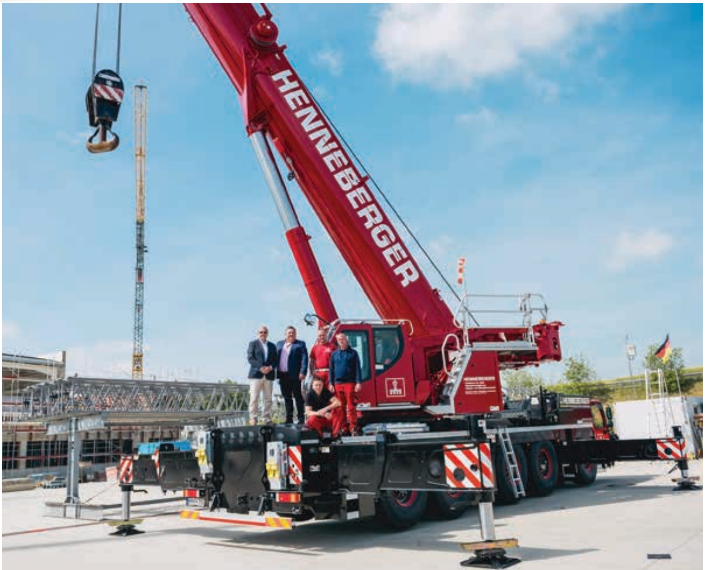
Henneberger Schwerlast hat einen neuen LTM 1250-5.1 übernommen. Der 250-Tonner von Liebherr ist nun der stärkste Kran in der Flotte des Thüringer Kranvermieters. Für ihn sind Einsätze vorgesehen bei der Montage schwerer Maschinenteile in der Automobilindustrie wie auch von Betonfertigteilen und Turmdrehkränen. <<
