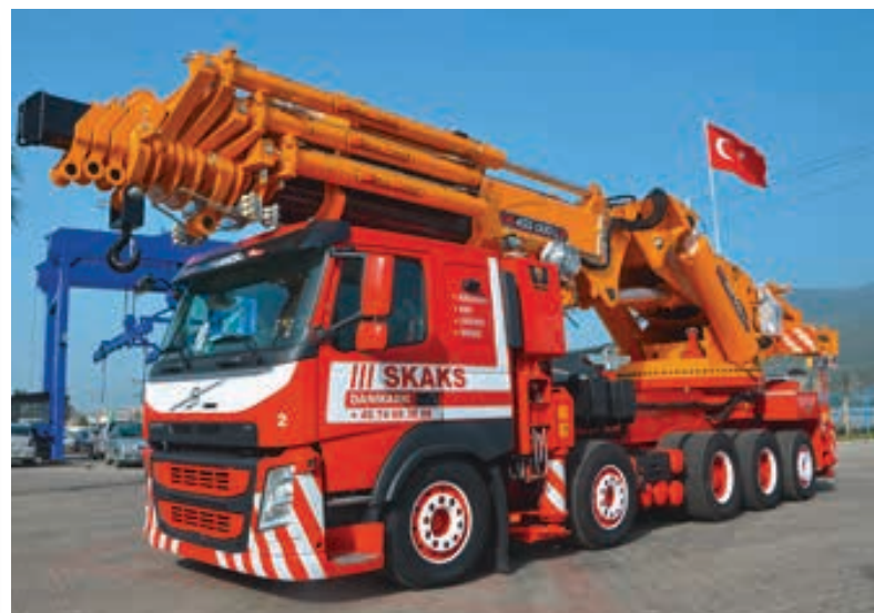
150 Tonnen und 450 mt Lastmoment bietet der ER-455.000 von World Power Erkin, betrieben von Skaks aus Dänemark
