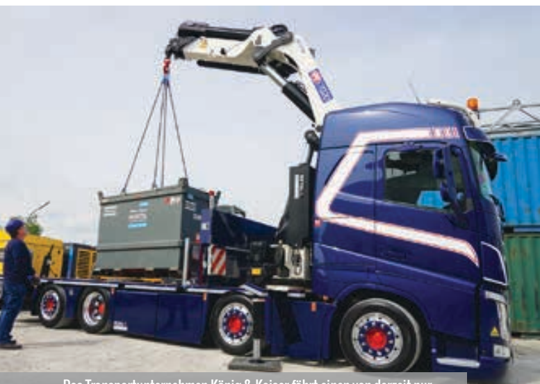
Das Transportunternehmen König & Kaiser fährt einen von derzeit nur sechs in Deutschland zugelassenen LKWs, die sich per Drimote-Fernbedienung steuern lassen. Als Ladekran thront ein HMF 7020-OK6 obendrauf
