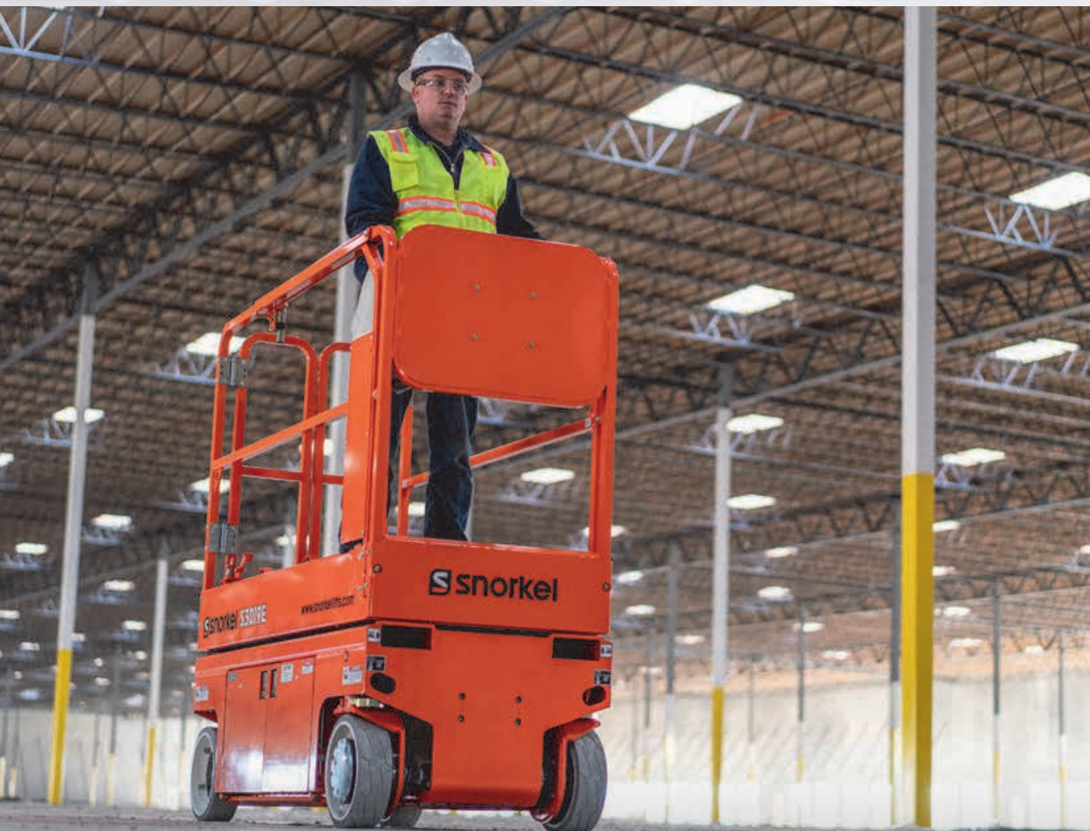
SNORKEL™ S3019E: BATTERIEBETRIEBENE SCHERENARBEITSBÜHNE NIEDRIGER EINSTIEG | ELEKTRISCHE LENKUNG | NULL INNERER WENDERADIUS
