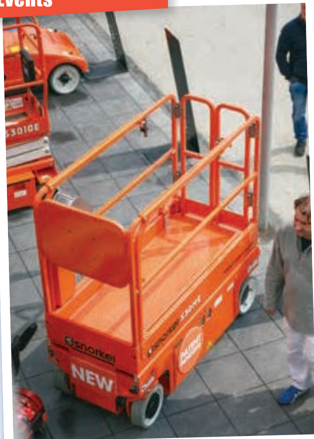
Snorkel zeigte sein Konzept des verstaunten Scherenpaketes
