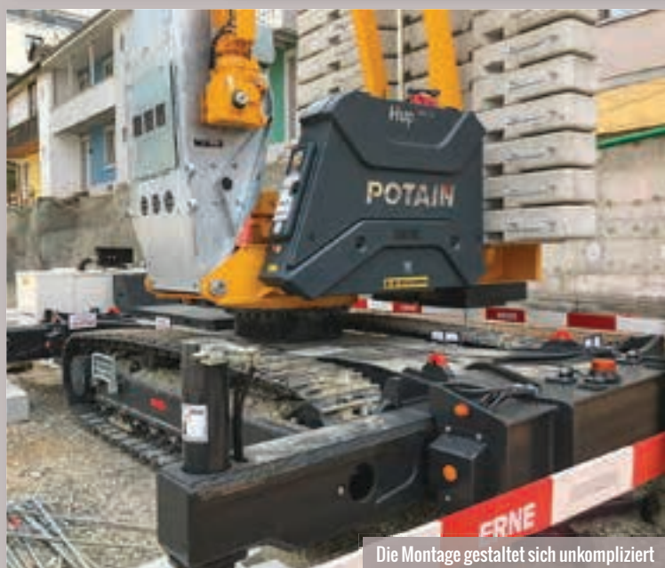
Dank Kette eignet sich der Kran gut für unwegsames Gelände
