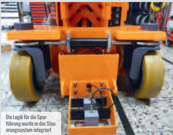
Blick auf die Controller der Fahrmotoren und - in der Mitte vor dem Schaltkasten - den Neigungssensor, der als Sicherheitselement ebenfalls in die Steuerung integriert wurde
