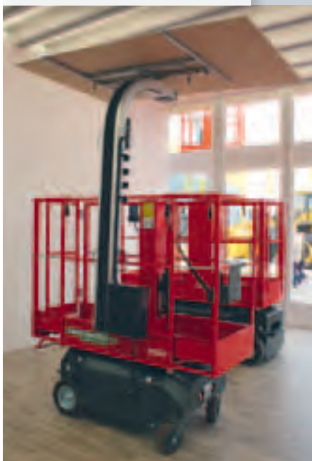
Der Leonardo von Bravi mit Anbauelement zur Installation von Gipskartonplatten
