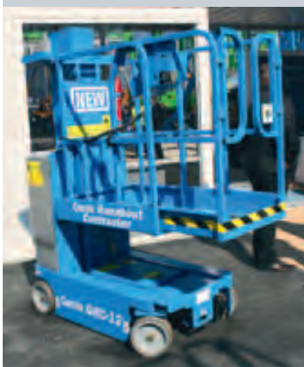
Seiner „Runabout“-Serie hat Genie nun Saloontüren für leichteres Ein- und Aussteigen gegeben
