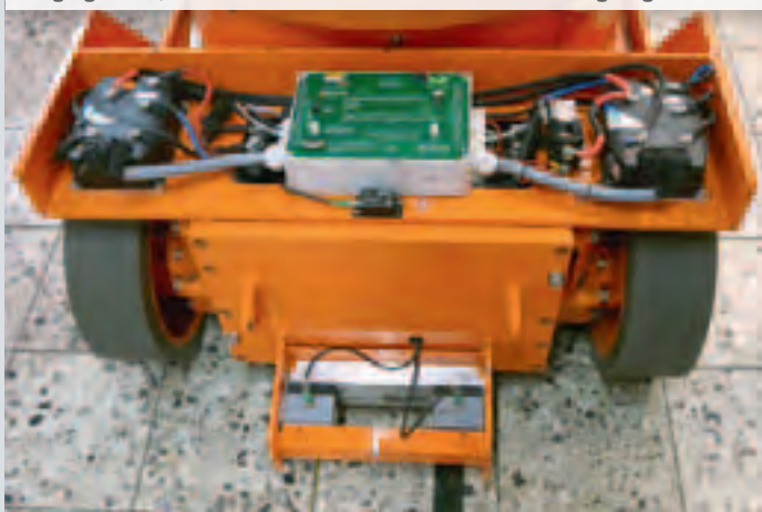
Blick auf die Controller der Fahrmotoren und - in der Mitte vor dem Schaltkasten - den Neigungssensor, der als Sicherheitselement ebenfalls in die Steuerung integriert wurde
