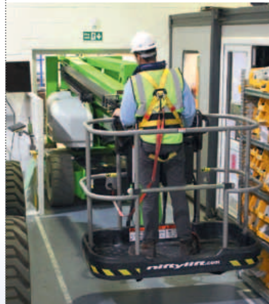
Die HR17N von Niftylift mit 1,99 Metern Fahrhöhe bei der Durchfahrt durch eine Normtüre
