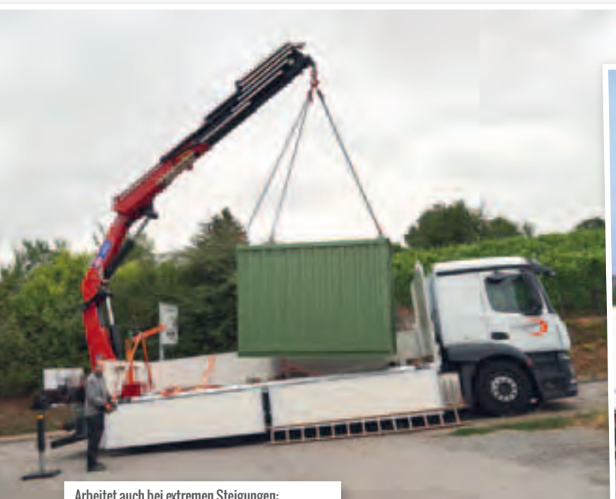
Arbeitet auch bei extremen Steigungen: der HMF 3220-k mit „Electronic Vehicle Stability“
