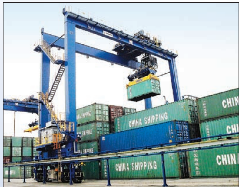
24 gummibereifte Terex Containerstapelkrane sind an Asyaport ausgeliefert worden
