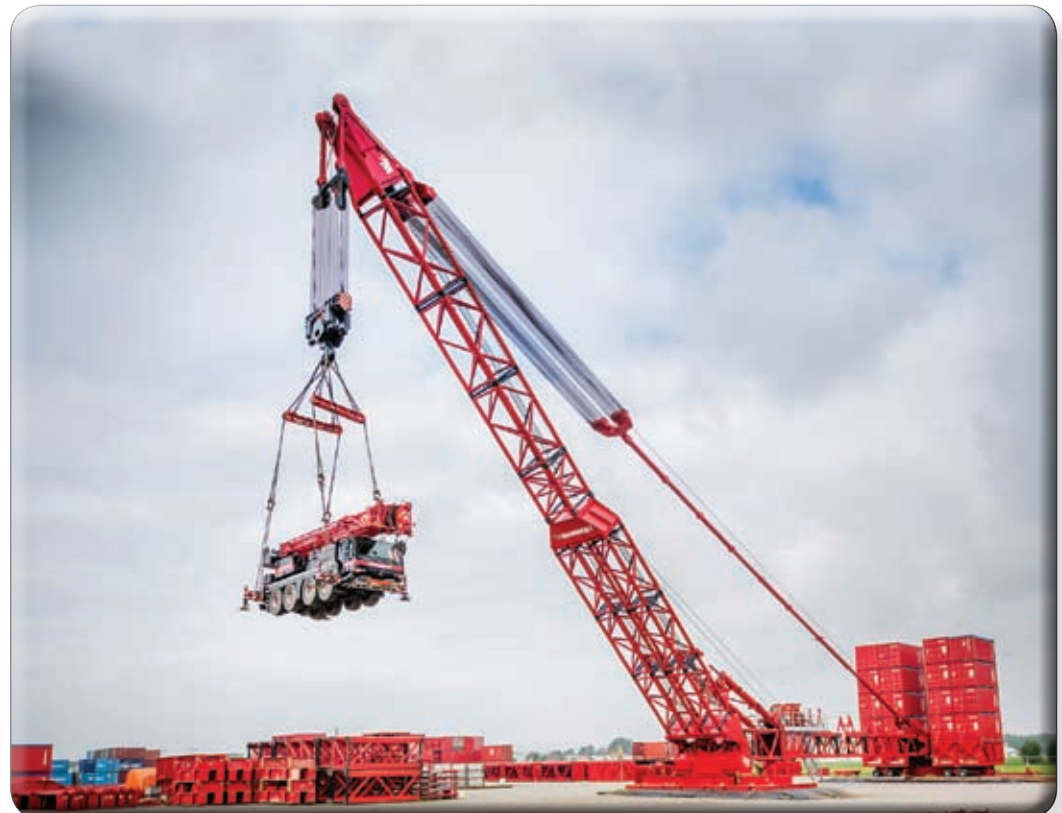
Mammoets MTC15 ist ein 600-Tonnen Kran
