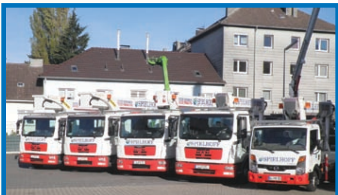
Gleich fünf neue LKW-Bühnen von Palfinger verrichten nun ihren Dienst in der Flotte des Wuppertaler Unternehmens Spielhoff. Die Hubarbeitsbühnen mit maximalen Arbeitshöhen von 21 bis 30 Metern sind auf verschiedenen Fahrgestellen aufgebaut.
