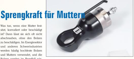
selfläche. Der Mutternsprenger besteht aus einem Hydraulikzylinder und dem Schneidkopf. Diese können je nach Gewindegröße ausgetauscht werden und sind dadurch flexibel einsetzbar. Der Mutternsprenger wird in der Regel mit einer Handpumpe, Manometer und Schlauch bedient. Auch eine Unterwasserversion ist erhältlich.
