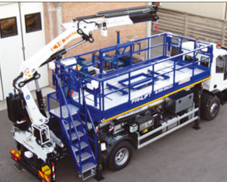
Unter der Bezeichnung Fanlift wird dieser kombinierte Aufbau – Arbeitsbühne und Ladekran – von SkyAces vermarktet
