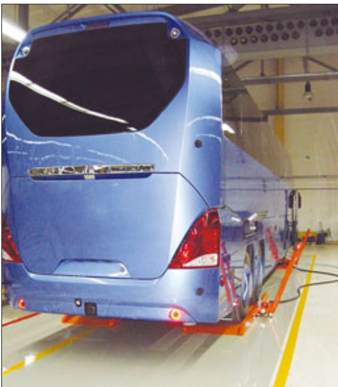
Bus auf Luftkissentransporter: Solving-Technik bei Neoplan
