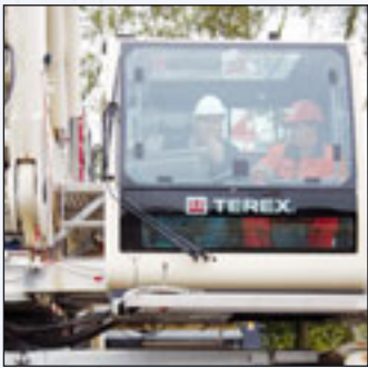
Die größere Kabine bietet auch Platz für eine zweite Person, zum Beispiel für die bessere Einweisung des Kranfahrers
