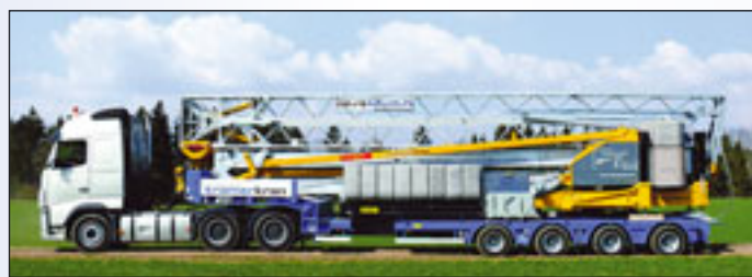
Alle Kran werden mit diesem einen Gespann umgesetzt. So sind bis zu zwei Auf- und Abbauten am Tag machbar
