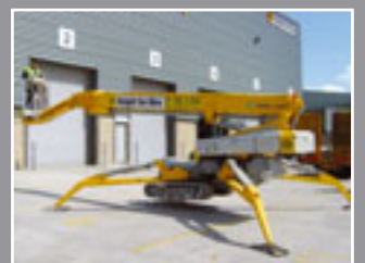
Omme 3000 RBD Spezialgerät 30m - 2006/7/8
