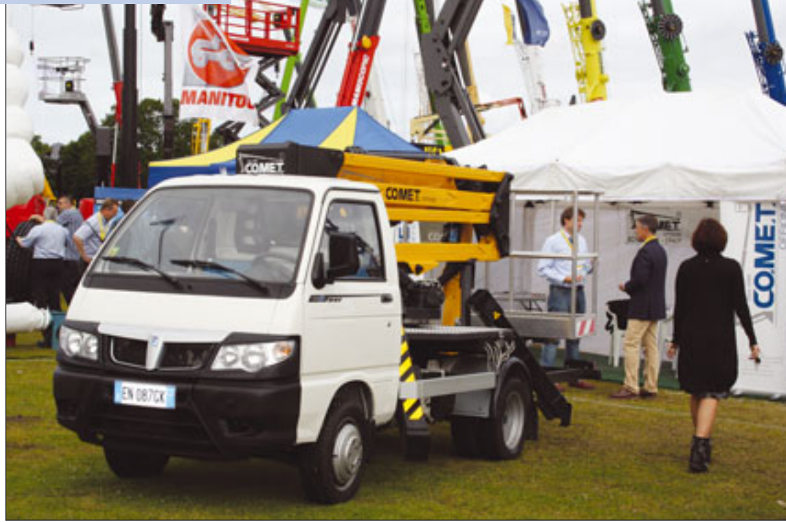
Eine LKW-Bühne auf Piaggio Porter baut Co.met auf. Die Arbeitshöhe liegt bei 14 Metern.
