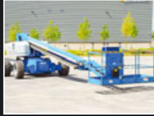
Genie S-85 Teleskopgelenkbühne 27,91m - 2005/06/7/8
