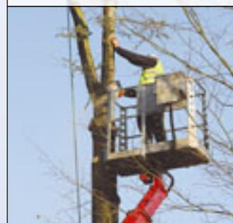
Stammstücken. „Dazu wird zunächst ein Seil um den Ast geschwungen“, erläutert Leveringhaus und fügt an: „erst dann beginnen wir mit dem eigentlichen Fällen. Durch die Korbdrehvorrichtung von zwei mal 90 Grad – ebenfalls ein Novum in dieser Arbeitsklasse – können wir mit dem TB 270 hervorragend am Baum navigieren, die kompletten Arbeitsschritte erledigen, ohne dabei die Arbeitsbühne versetzen zu müssen.“
