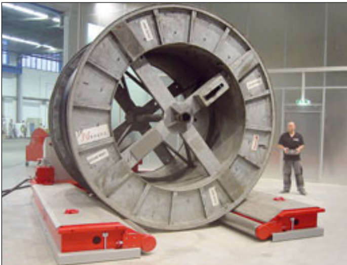
Nexans bettet seine Kabeltrommeln auf Luftkissen von Solving
