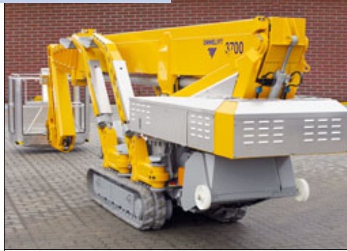
Auf 37 Meter Arbeitshöhe kommt die neue Omme
