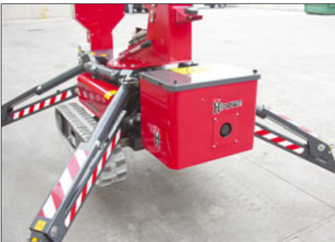
Hinowa setzt bei den Batterien auf die Lithium-Ionen-Technik
