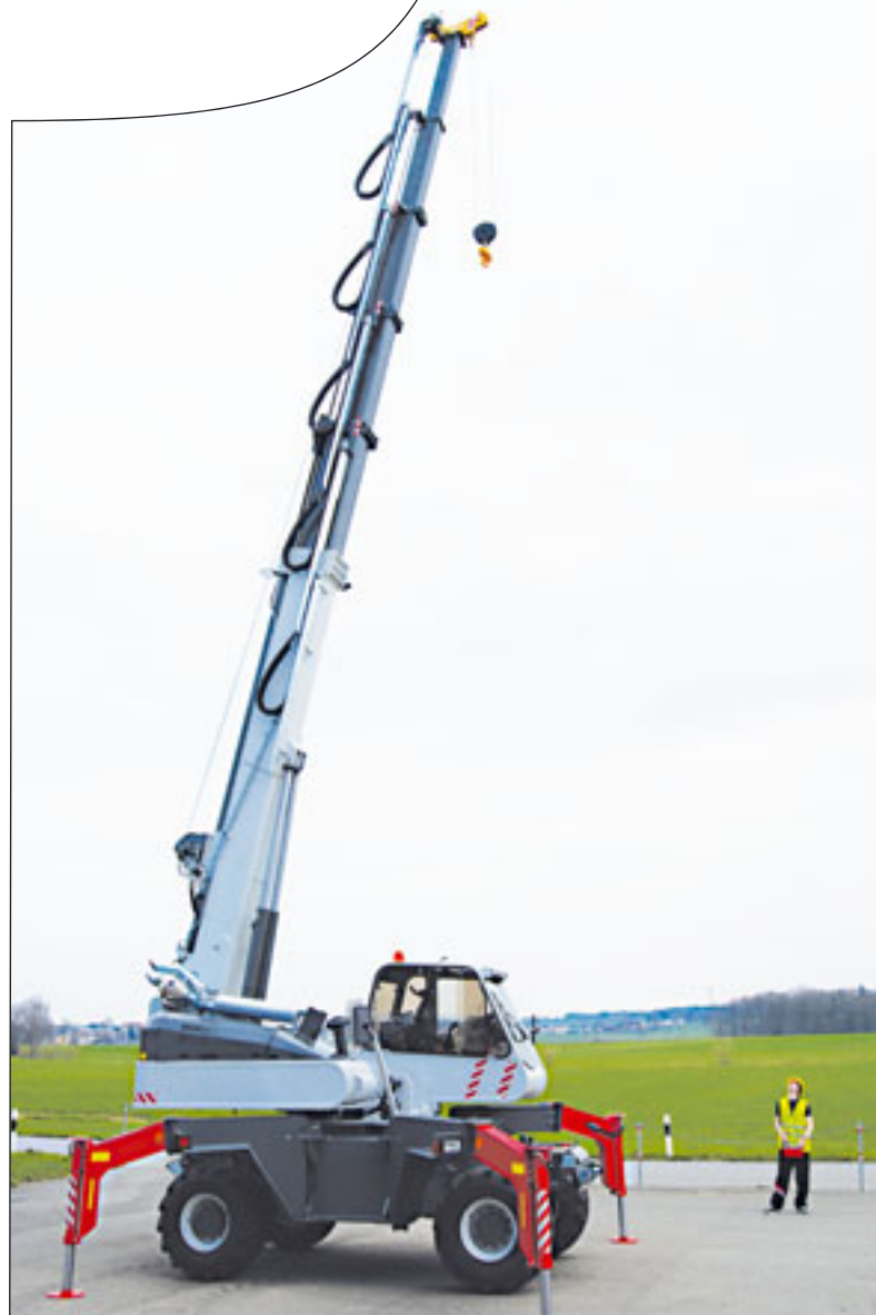
Der neue Jakob Herkules schafft Hubhöhen von über 30 Meter
