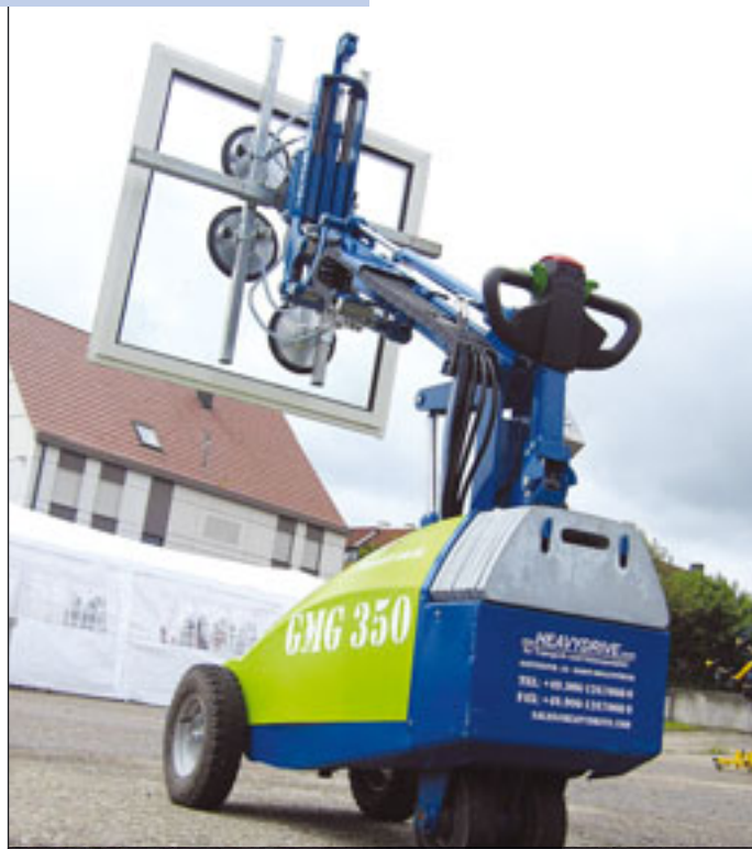
Auf den Einbau von Glasscheiben ist der GMG 350/550 ausgerichtet
