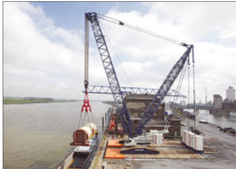
Für den Rücktransport eines Stators, dem Stahlgehäuse eines Stromgenerators, zum Herstellerwerk in Polen zogen die drei Schwerlastlogistiker Viktor Baumann, Riga Mainz und Breuer & Wasel an einem Strang. Für den Umschlag im Krefelder Hafen nahm der LR 1600/2 von Breuer & Wasel den Stator in Empfang und hob diesen mit einer Gesamtlast von 484 Tonnen ins Binnenschiff.
