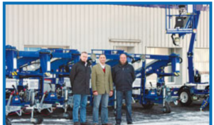
Acht Anhängerarbeitsbühnen vom Typ AB 122 GTE von Niftylift hat Beyer MietSERVICE in seinen Vermietpool aufgenommen. Die Maschinen bieten eine Arbeitshöhe von 12,20 Meter und eine seitliche Reichweite von 6,10 Meter. Per Joystick und Radantrieb kann die Bühne individuell verfahren werden. Der eigene Fahntrieb erfordert lediglich einen 220-Volt-Stromanschluss. Die kompakten Maße von 4,57 Meter Länge und 1,50 Meter Breite bieten gute Bedingungen für enge Zufahrten oder Wege. Die Maschinen nahm Dieter Beyer (r.) persönlich in Empfang.
