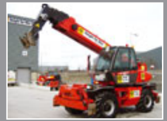
Manitou MRT 2150 Telestapler 21m/5 Tonnen - 2005/6
