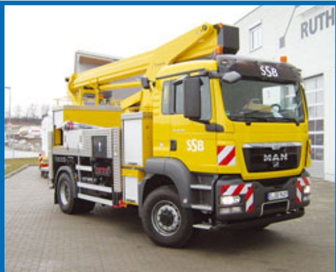
Die Stuttgarter Straßenbahnen AG (SSB) hat eine neue T 275 von Ruthmann in Empfang genommen. Die Bühne ist auf ein 18 Tonnen MAN 18.320 Chassis aufgebaut und bietet eine maximale Reichweite von gut 21 Metern in der Horizontalen.
