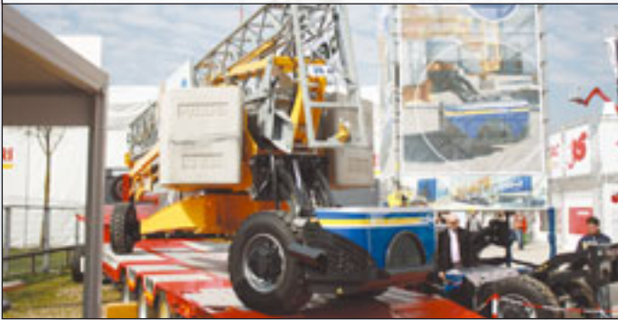
Einen Einachser zum punktgenauen Positionieren eines Untendreihers hat das italienische Unternehmen Gapo entwickelt
