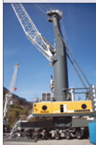
30 Tonnen am Haken hat der neue LHM 550 hier
