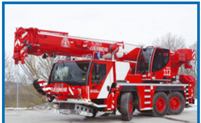
Die Berliner Feuerwehr übernahm einen neuen Feuerwehrran der Marke Liebherr LTM 1050-3.1. Der dreiachsige 50-Tonner führt mit voller Ausrüstung noch 4,4 Tonnen Ballast mit. Die Berliner Feuerwehr hat für Ihren Kran feuerwehrspezifische Zusatzausstattung ausgewählt, die sich auch bei anderen Liebherr-Feuerwehrranen im Berge- und Abschleppereinsatz bewährt hat.
