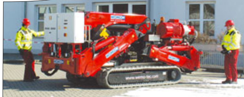
Dieser kompakte SMK 320.67 kommt auf eine Hakenhöhe von 32 Metern
