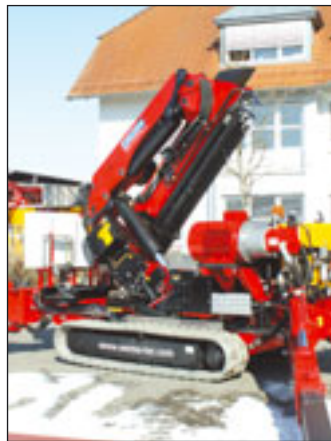
Dank des aufrichtbaren Turms kommt das Gerät auf seine sehr kompakten Maße
