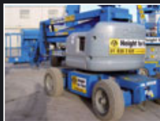
Genie Z-45/25J Bi Energy Teleskopgelenkbühne 16m - 2002/3/4/5/6
