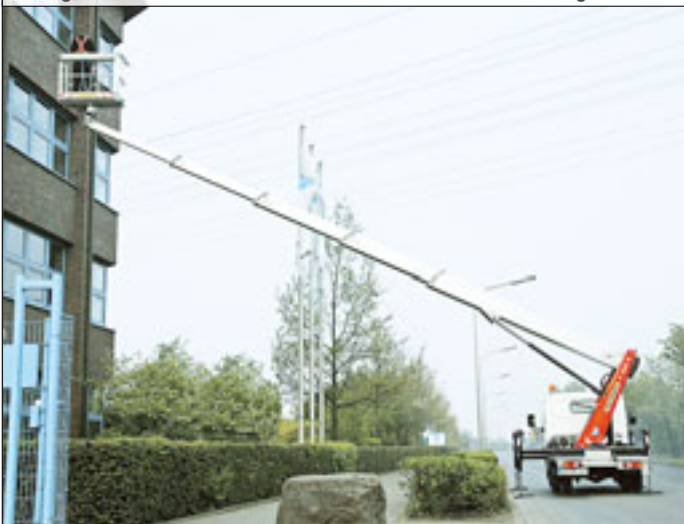
Palfinger setzt bei seiner P 260 B auf Aluminium für den Ausleger
