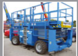
Genie GS-3384 RT Diesel Scherenbühne 12m - 2006
