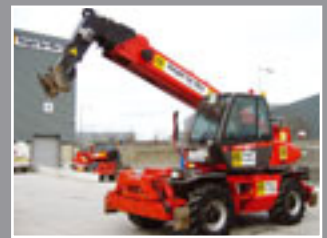
Manitou MRT 2150 Telesapler 21m/5 Tonnen - 2005/6
