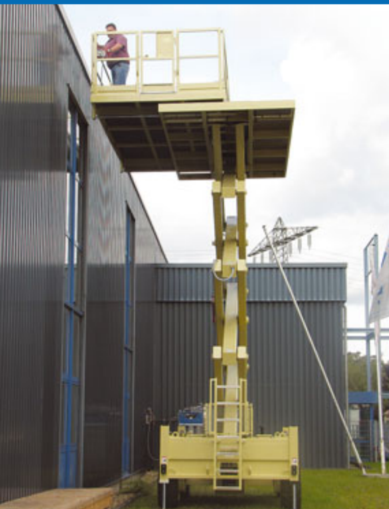
H.A.B. hat eine neue 16-Meter-Scherenbühne für Tunnel- und Fassadenarbeiten entwickelt. Dank 1,20 Meter seitlichem Ausschub kann über Beete oder ähnliches hinweg gearbeitet werden. Die ersten vier Maschinen gehen an das französische Unternehmen Carriesopic.
