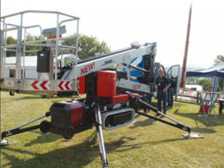
Das Megadeck von PB lässt vollhydraulisch ausfahren
