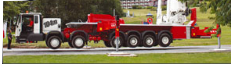
Die neue Rekordmaschine von Bronto mit 104 Metern Arbeitshöhe: die S104HLA
