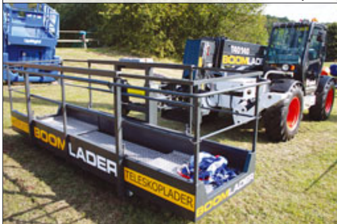
Boomlader nennt Meis seinen Arbeitsbühnenanbau für Bobcat-Teleskoplader
