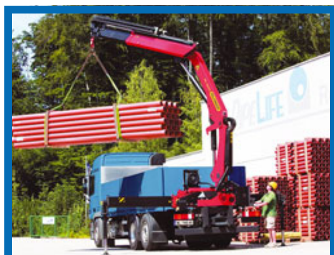
Einen ganzen Schwung neuer Modelle aus der „High Performance“-Baureihe hat Palfinger auf der Matexpo in Belgien vorgestellt: drei Modelle in der 13/14m-Klasse und im Bereich 16- bis 18mt ebenso drei Neuheiten, darunter der PK 16001 (siehe Bild). Als Neuheit bei den Knickarmkranen kommt das System Single Link Plus: Es ermöglicht die Überstreckung des Knickarms um 15 Prozent.
