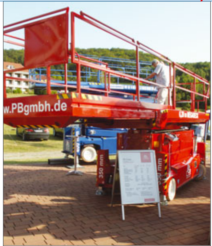
Das Megadeck von PB lässt vollhydraulisch ausfahren
