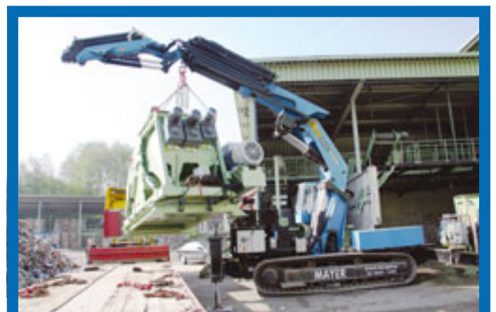
Ungewöhnliches Bild: Das Unternehmen Mayer Autokran hat einen „normalen“ Schwerlastkran PK 150002 von Palfinger auf Raupenfahrgestell geordert. Hier ging es im Geiger-Werk Betzigau um den Austausch eines Nachzerkleinerers mit einem Gewicht von knapp 16 Tonnen.
