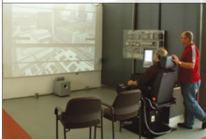
Am Simulator kann im „trockenen“ geübt werden, um so die Reaktionen eines Kranes kennen zu lernen und sich mit den verschiedenen Perspektiven auseinander zu setzen
