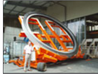
In Biberach werden auch Komponenten wie beispielsweise dieser Drehkranz für Windräder produziert
