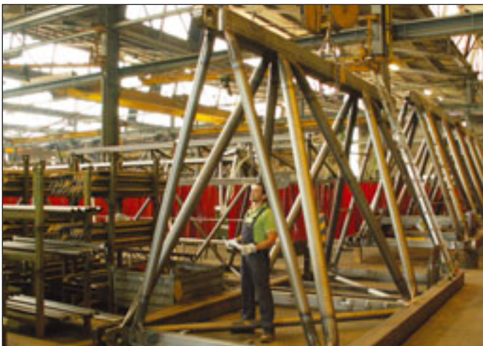
Mit der HC-Baureihe, zu der dieses Auslegerteil gehört, bietet Liebherr Geräte mit einer Traglast bis zu 80 Tonnen an
