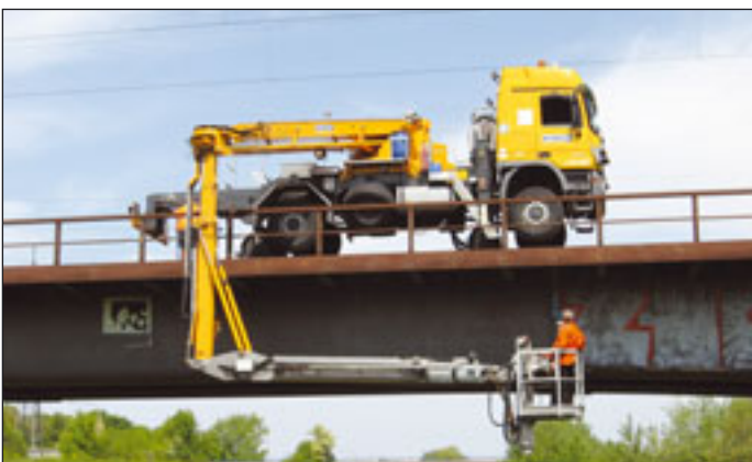
Die MBL1200 verfügt über eine horizontale Reichweite von zwölf Metern, die größeren Modelle reichen bis 16 Meter unter das Bauwerk
