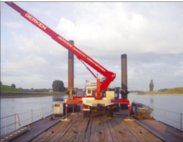
Zur Inspektion der im Jahre 1933 erbauten Hubbrücke über das Hafenecken des Nordhafens in Duisburg-Walsum setzte Gerken auf die „schwimmende Lösung“, sodass eine Prüfung vom Wasser aus möglich war.
