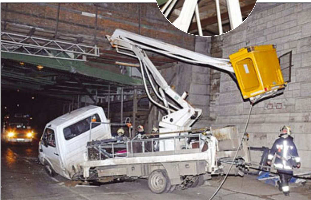
Der Ausleger dieser LKW-Bühne hat sich in der Brücke verhakt, da auch hier die Höhe falsch eingeschätzt wurde. Der Schaden an der Maschine ist beträchtlich, der Fahrer kam mit leichten Verletzungen davon.
