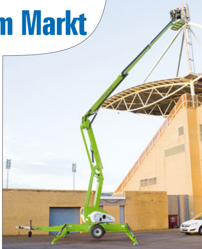
Die Niftylift 210 verfügt über eine Korblast von 225 Kilogramm auch bei voller Reichweite von 12,15 Metern
