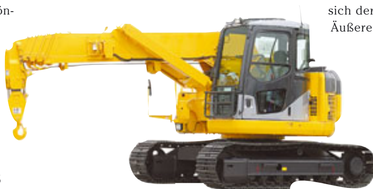
Ein solcher Maeda LC 1385M-8B mit einer Tragkraft von sechs Tonnen steht bald in den Diensten von Uplifter
