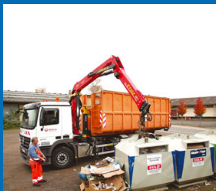
Ein neuer Mercedes-Truck, bestückt mit einem Epsilon-Recyclingkran und Palift-Technik, ist im Dienst der Umwelt bei der Firma Veolia im Einsatz. Vom Standort Grünstadt im Südwesten Deutschlands aus fährt der Actros 2544 vorrangig im Containerdienst für die Leerung kommunaler Sammelcontainer.
