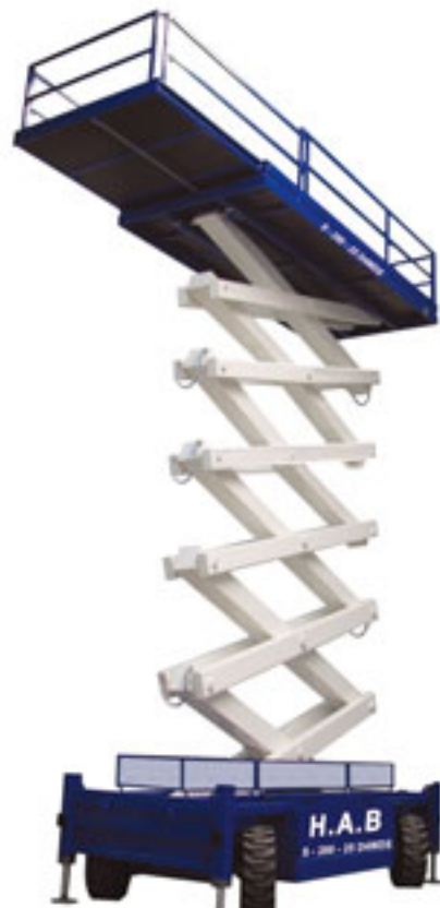
H.A.B.s große Scherenbühne S280-25 kommt auf 28 Meter Arbeitshöhe
