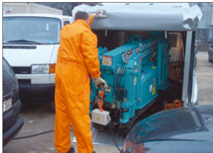
Minikrane passen auf den kleinsten Hänger, so wie dieser Maeda MC 104
