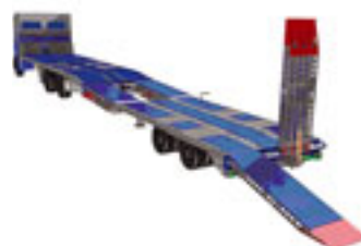
Durch ein Ablegen der Rampen des Zugfahrzeugs von Zanner im gefalteten Zustand auf die Anhängerfront kann der komplette Zug von hinten über die einteiligen Rampen des Anhängers beladen werden.
