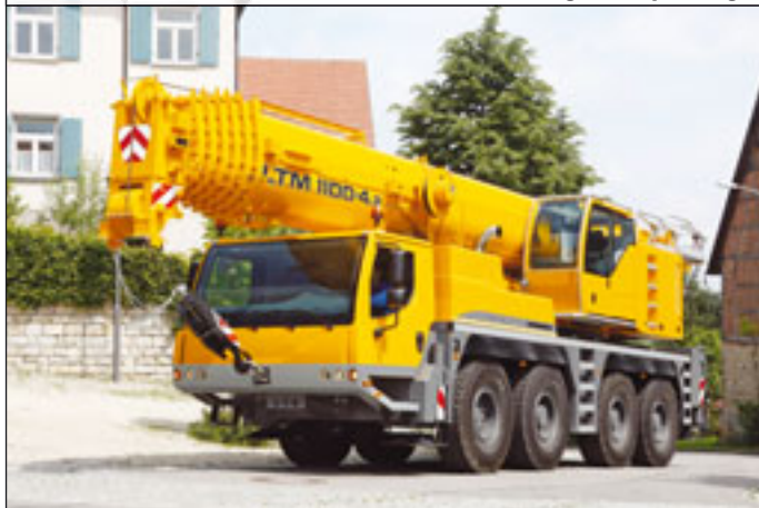
Liebherr's Neuster, der LTM 1100-4.2 mit 60 Meter langem Hauptausleger
