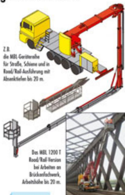
Z.B. die MBL-Gerätereihe für Straße, Schiene und in Road/Rail-Ausführung mit Absenktellen bis 20 m.
