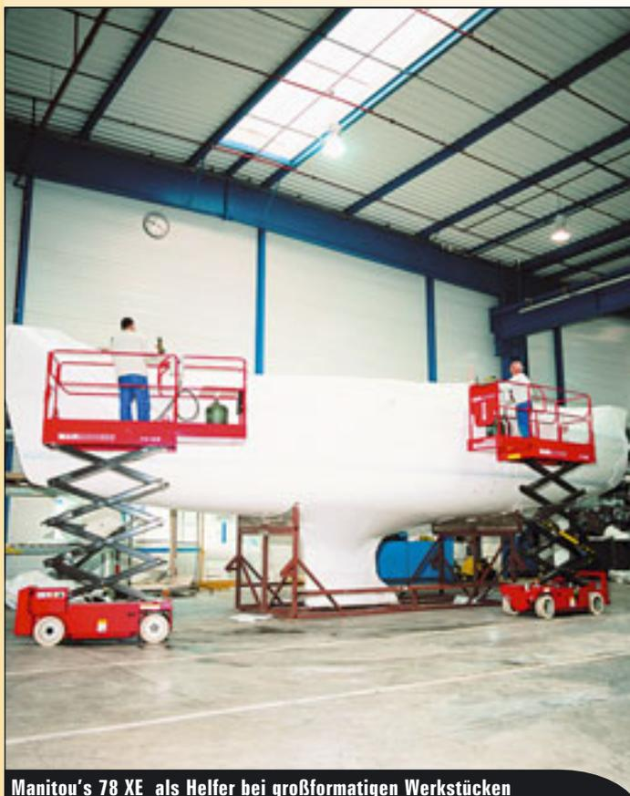
Manitou's 78 XE als Helfer bei großformatigen Werkstücken
