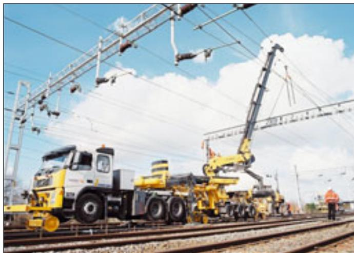
Das größte Zwei-Wege-Fahrzeug weltweit wurde jüngst in England in Betrieb genommen. Aufgebaut auf einem Sattelzug, ist dieser PKR 750E im Fahrleitungsbau im Einsatz. Der Knickarm lässt sich um bis zu 80 Grad überstrecken.
