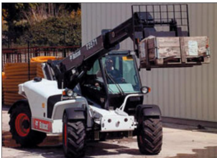
Bobcat hat einen neuen Teleskop der Sieben-Meter-Klasse auf den Markt gebracht. Das T 3571 genannte Modell löst den Vorgänger T3071 ab. Der Neue zeichnet sich nach Herstellerangaben durch verbesserte Leistungseigenschaften aus. So bietet er eine maximale Hubkraft von 3,5 Tonnen gegenüber drei Tonnen beim Vorgängermodell. Die maximale Hubhöhe erhöhte sich auf 7,12 Meter. Auch bei der Reichweite
