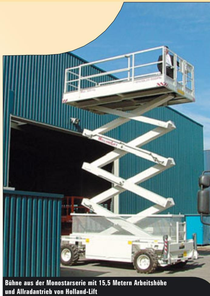
Bühne aus der Monostarserie mit 15,5 Metern Arbeitshöhe und Allradantrieb von Holland-Lift
