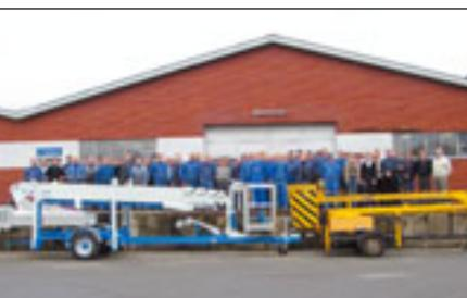
Das Foto zeigt die 5000. Bühne zusammen mit der ersten von Omme gefertigten Bühne aus dem Jahr 1981. Die erste Bühne hat eine Arbeitshöhe von neun Metern. Das Jubiläumsmodell ist eine Anhängerbühne Typ 2500 EBDZ mit einer Arbeitshöhe von 25 Metern. Die Bühne hat einen kombinierten Antrieb (Batterie/Diesel). Mehr unter:
