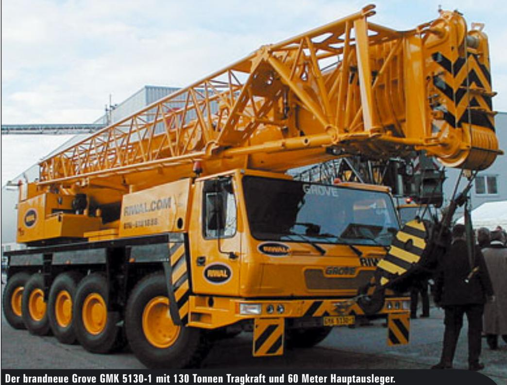
Der brandneue Grove GMK 5130-1 mit 130 Tonnen Tragkraft und 60 Meter Hauptausleger.
