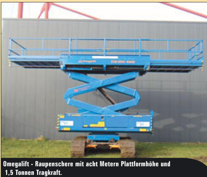
**Omegalift - Raupenschere mit acht Metern Plattformhöhe und 1,5 Tonnen Tragkraft.**
