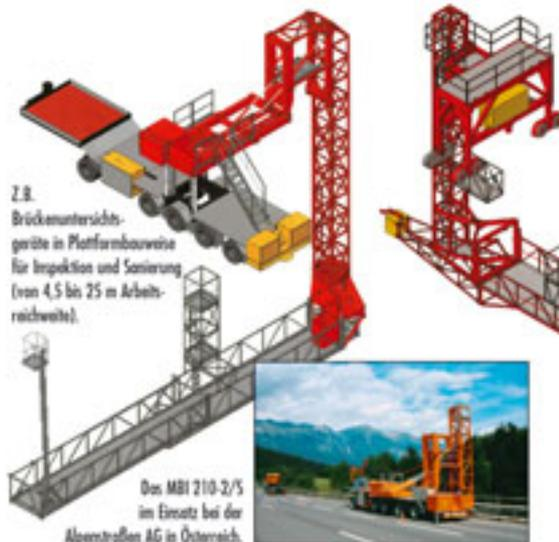
Z.B. Brückenuntersichtgeräte in Plattformbauweise für Inspektion und Sanierung (von 4,5 bis 25 m Arbeitsreichweite).
