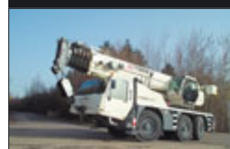
Der Terex Demag AC 55 L Drei-achser mit Hakenhöhe 59 Meter
