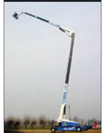
Satte 50 Meter Arbeitshöhe schafft der Basket 50 AJT
