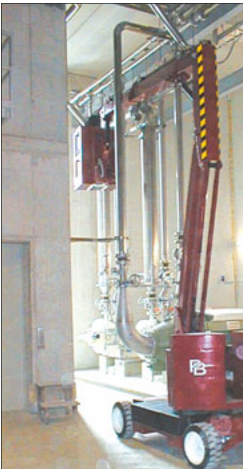
PB Liftechnik bietet nun auch einen „kleinen Drehkorb“ für Einsätze, bei denen es eng zugeht, an
