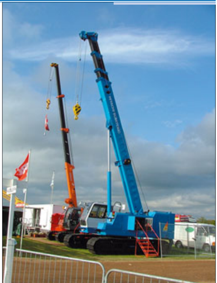
Europapremiere für die neuen Raupenkrane von Hitachi Sumitomo. Auf der SED war erstmals der neue SCX400T (im Bild rechts) zu bestaunen. Der 40-Tonner ist mit einem 32 Meter langen Hauptausleger ausgestattet worden.
