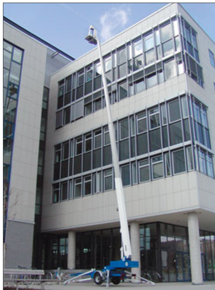
Kreitzler bringt eine neue Gelenkteleskopbühne auf den Markt. Die neue 26/420 T verfügt über eine Arbeitshöhe von 42 Metern.
