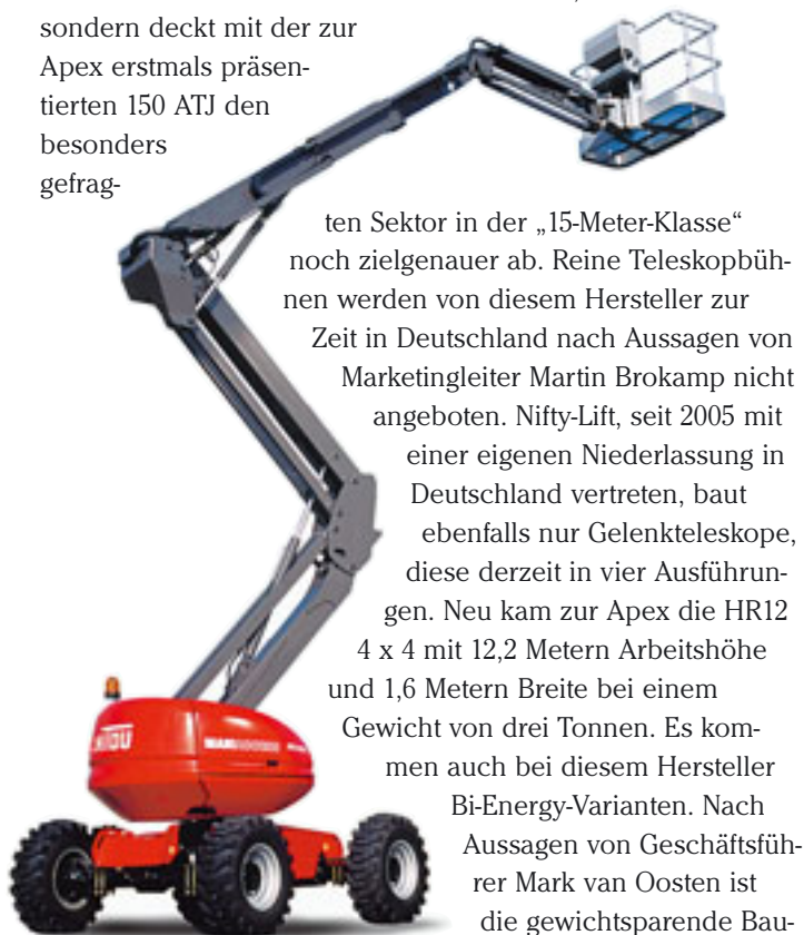
Die Größte in der Gelenkteleskop- Baureihe von Manitou ist die ATJ 180
