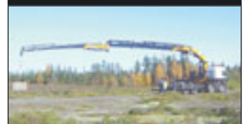
Ladekrane wie hier ein Effer 850-8 S müssen in der Lage sein, große Entfernungen zu überbrücken
