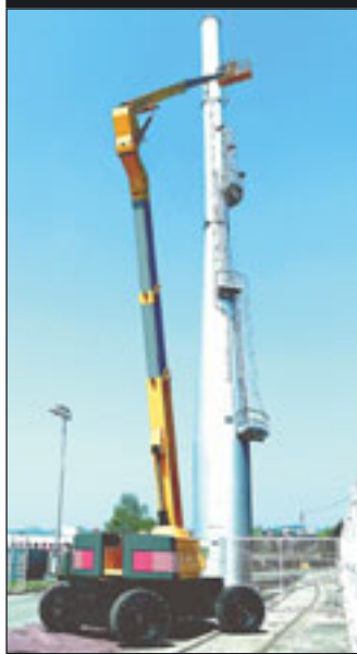
Haulotte HA 41 PX bei der Installation eines Antennenmastes
