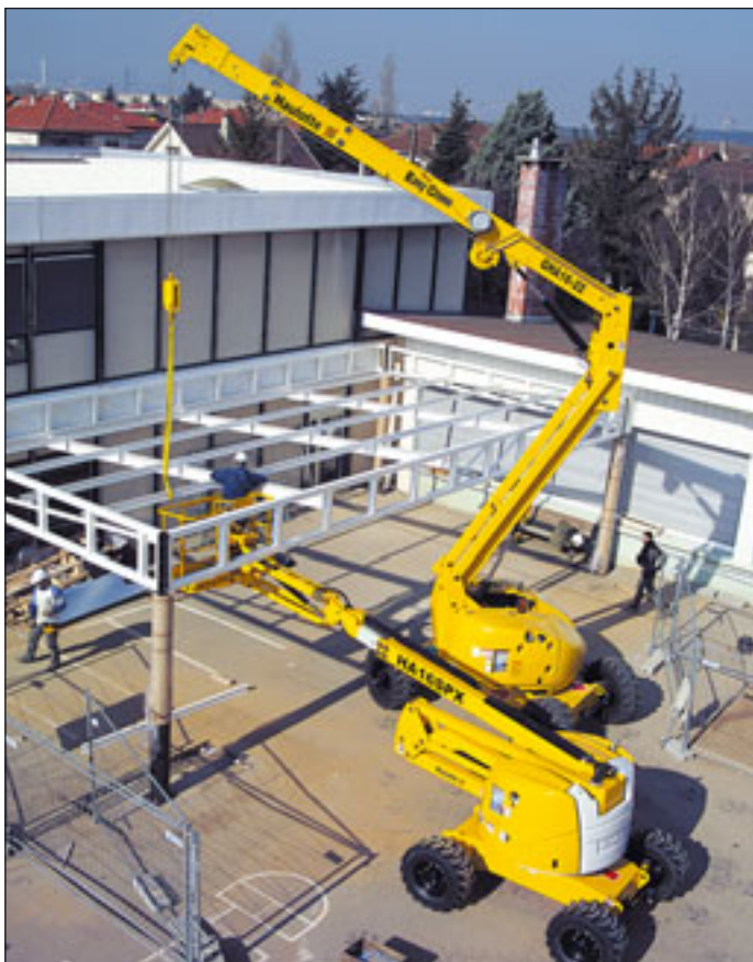
Mit einem neuen Konzept ist Haulotte vor drei Jahren auf den Markt gekommen. Der GHA 16-22 kann dank seinem Gelenk näher an Störkanten heran.
