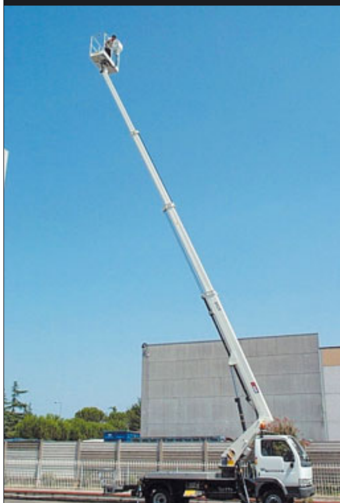
Arbeitshöhe 21,05 Meter sind bei der 2005 vorgestellten GSR 219 Standard
